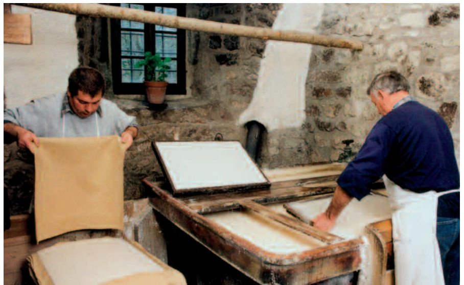
La cuve du moulin. Copyright moulin à papier, Richard de Bas.
